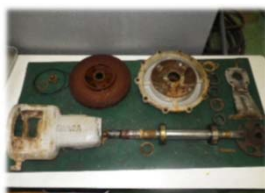
ポンプの分解整備 部品交換
