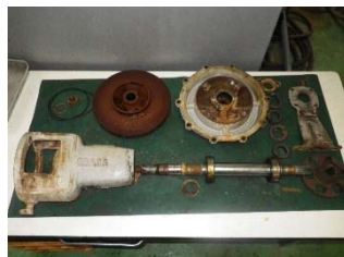
ポンプの分解整備 オーバーホール！
